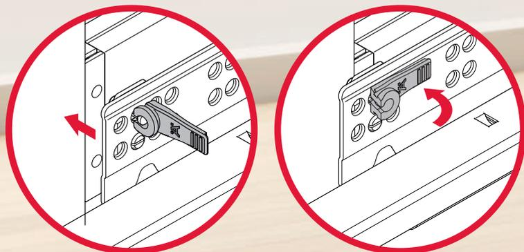
1. Enfiler la ferrure d'assemblage
